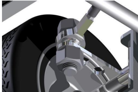
Fig. 74 Dos cuerdas sobresalientes sobre la tuerca de seguridad
