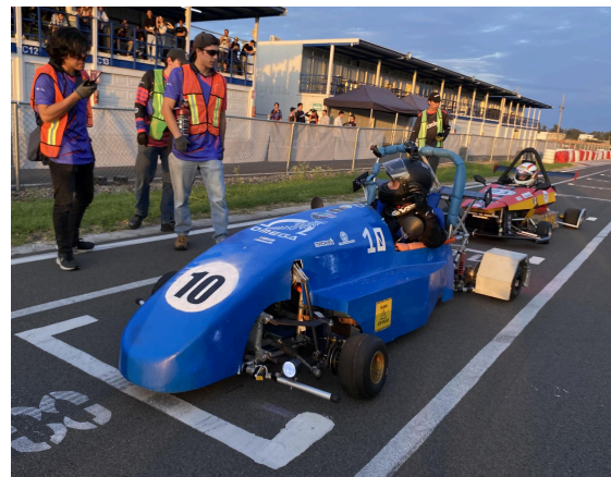
Fig. 83 Ejemplos, Carrocería de placa sólida de policarbonato Auto 00 y carrocería en fibra de vidrio Auto 10
