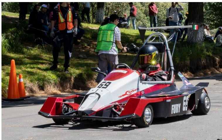
Fig. 80 Ejemplos, Carrocería de placa sólida de policarbonato Auto 22 y carrocería en placa solida de PVC Auto 69
