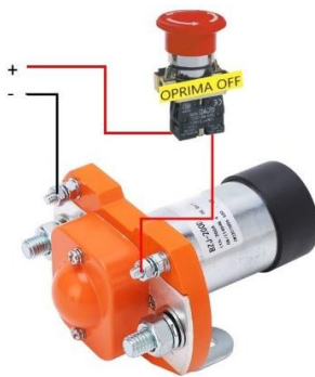
Contactor 250 A con Kill Switch 1 A
