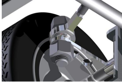
Fig. 71 Cuerdas sobresalientes sobre la tuerca de seguridad
