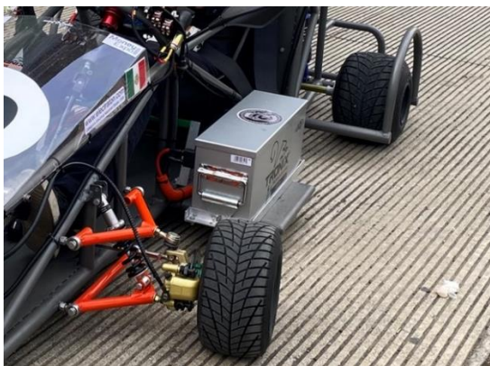
Fig. 59 Tipos de soportes y cubiertas de baterías de Litio LiFePO4
